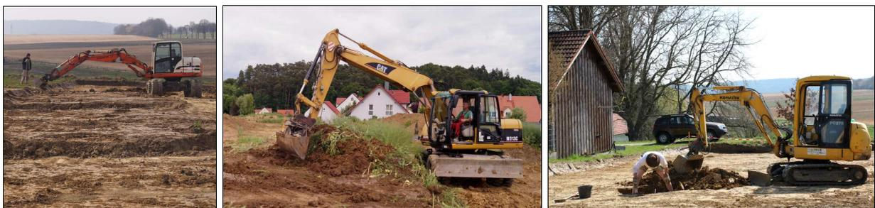
Abb. 8 Links: Schaeff-Mobilbagger. Mitte: CAT-Mobilbagger. Rechts: Komatsu-Minibagger.
